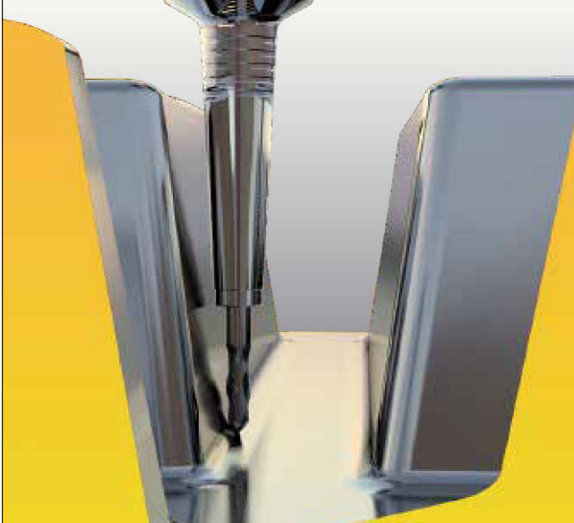
간섭이 있는 볼엔드밀 정삭가공 Finishing with ball endmill in tight space
