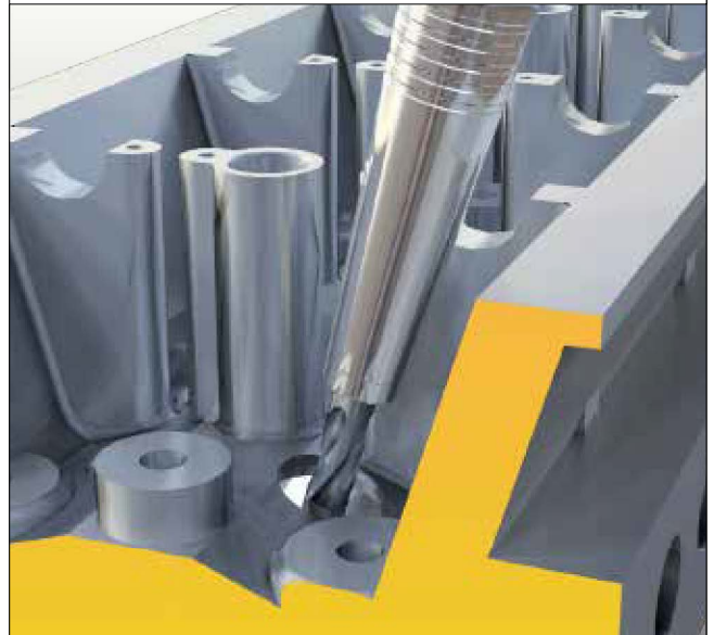
간섭이 있는 드릴가공 Drilling in tight space
